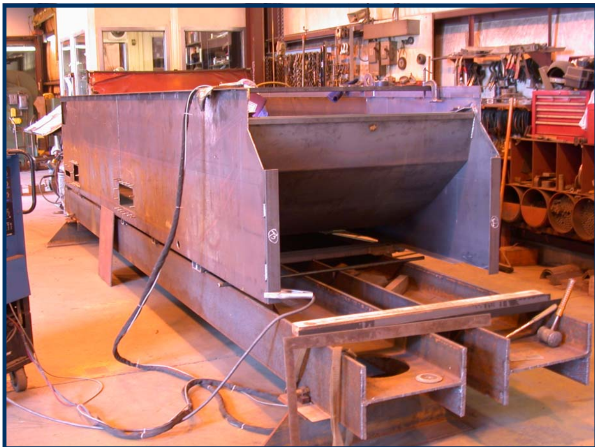
Fabricação do tanque de filtro padrão Vacu-Matic F1000 para uso em laminador de alumínio
