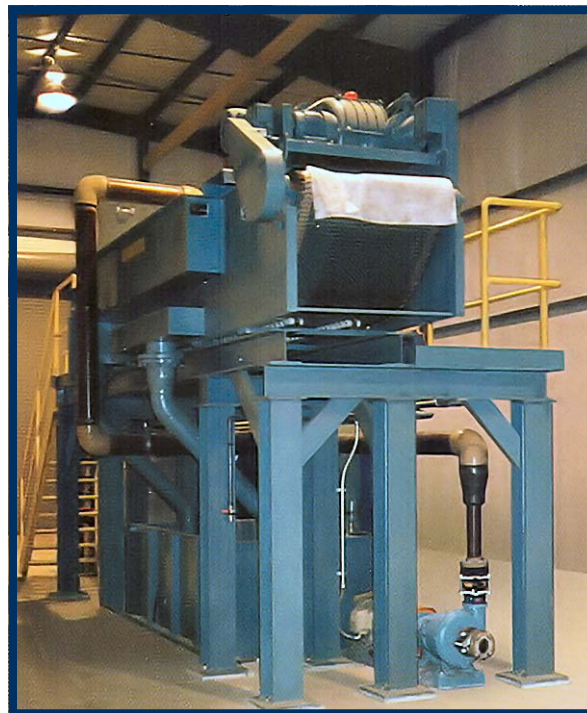
F-750 mostrado na fábrica de um cliente filtrando água contaminada de um “hotwell” de fresagem.
