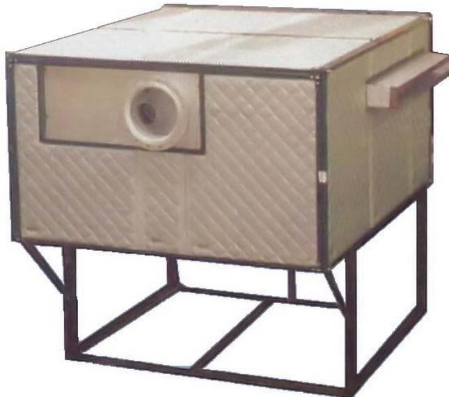
**水平ヘダーのサポートテーブル**には、4組の直径6インチ (152 mm), 30°“V”の、調整可能なスロットを備えたヘダー、出入り口のEDPMコーティングのヘダー保護ロール（表示されていません）、そして空気配布ボックスが装備されています。このユニットは、洗浄後の幅49インチ(1245mm)のスチール製のストリップを968 ft/min.(295 m/min.)の速度で乾燥させるために使用されます。
