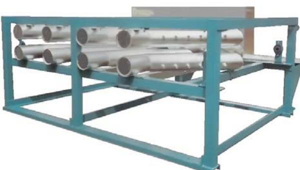
ストリップ乾燥システムには、化学薬品処理後用の間接型ガスヒーターが装備されています。このシステムは、72インチ(1830 mm)幅のストリップを最高600ft/min.(182 m/min.)の速度で乾燥するようにデザインされています。
