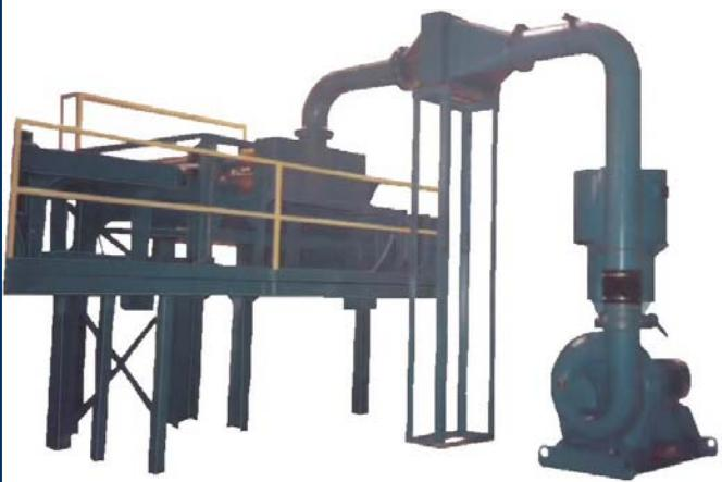
水平ヘーダーのサポート構造には、3組の直径6インチ (152 mm)、15° “V” の調整可能なスロット付きのヘーダー、出入り口のEPDMコーティングのヘーダー保護ロール、および空気配布ボックスが装備されています。このユニットは、冷却後に49インチ (1245 mm)幅のストリップを最高600 ft./min. (182 m/min.)の速度で乾燥するようデザインされています。
