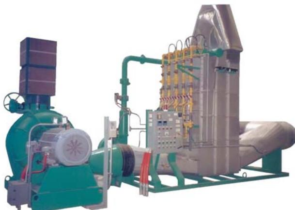
ストリップ乾燥システムには、スチーム・ヒータがブッシュ・プル式酸洗浄部分に装備されています。このシステムは、72インチ (1830 mm) 幅のストリップを最高500 ft./min. (152 m/min.) の速度で乾燥するようにデザインされています。
