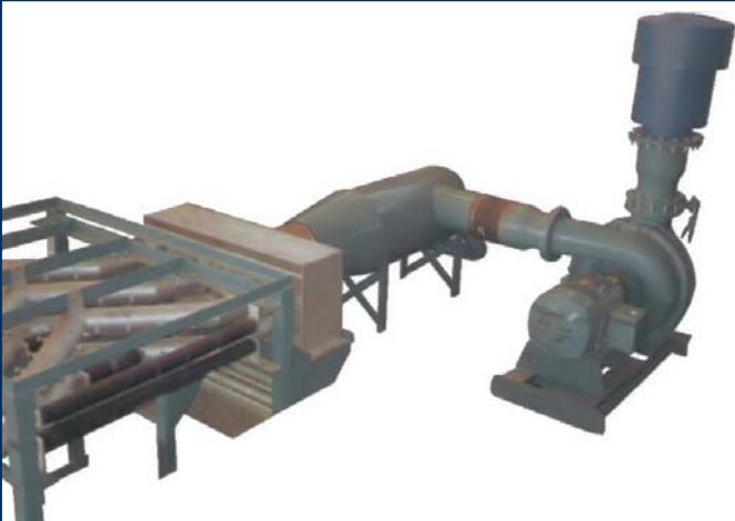
ストリップ乾燥システムには、化学薬品処理の部分の後に設置された直火型ガスヒーターが装備されています。このシステムは、49インチ (1245 mm) 幅のストリップを最高600 ft./min. (182 m/min.) の速度で乾燥するようデザインされています。
