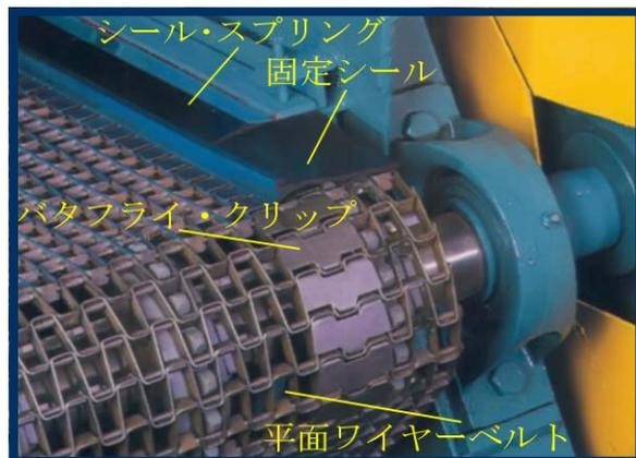
永久バタフライ・クリップ付の平面ワイヤー・コンベアベルト；ステンレススチール製の押し下げスプリングで固定された固定シール
