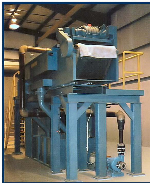
研磨用加熱曹からの汚染水を、顧客の工場で濾過している F-750 を表示しています。II
