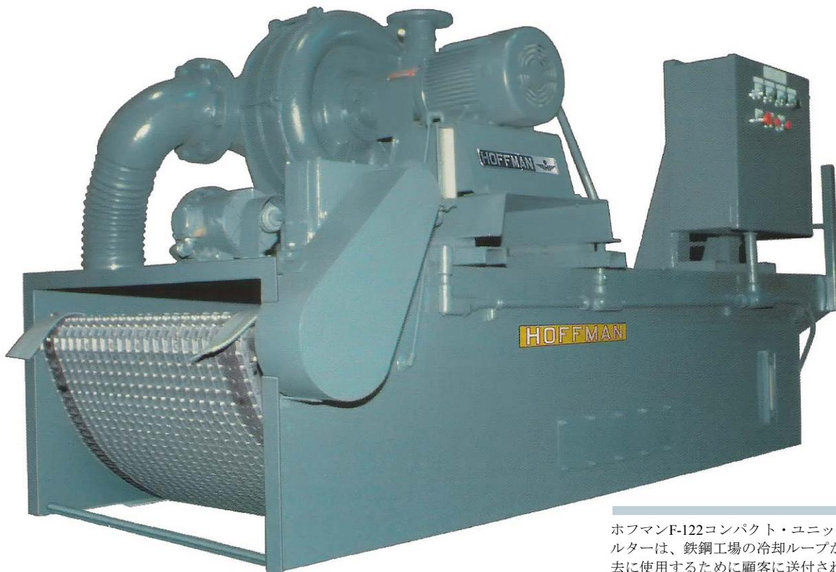
ホフマンF-122コンパクト・ユニット；表示されたフィルターは、鉄鋼工場の冷却ループからの金属固形物の除去に使用するために顧客に送付されたものです。
