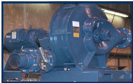
Aspiratore 4203A Gardner Denver e motore da 20 HP su filtro Vac-1000
